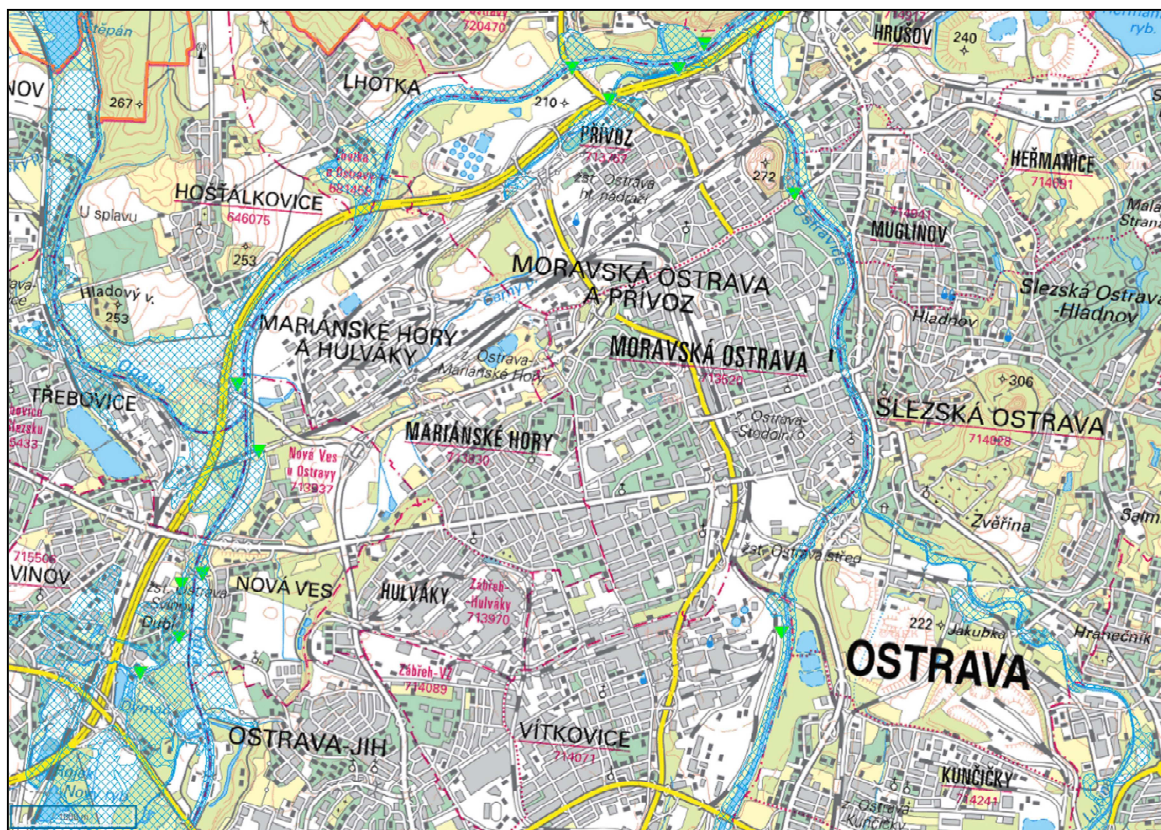
Obrázek 2: Realizovaná protipovodňová opatření na území Statutárního města Ostravy (zelené trojúhelníky) a záplavové území při Q 100 po jejich realizaci (Zdroj: Povodňový plán města Ostravy )
