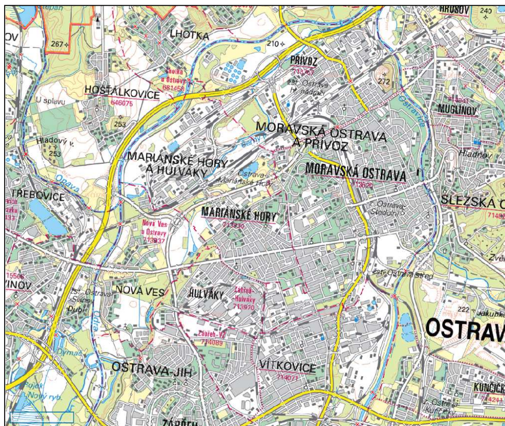
Obrázek 2 Místa omezující odtokové poměry na území Statutárního města Ostravy (červené křížky) a záplavové území při Q100 po jejich realizaci (Zdroj: Povodňový plán města Ostravy)
