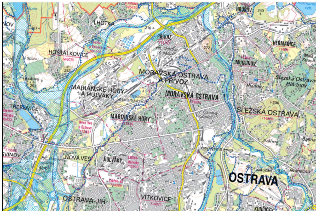
Obrázek 1 Srovnání rozsahu záplavového území v roce 1997 (tmavě modrá čára) a po realizaci protipovodňových opatření (světle modrá šrafovaná plocha) na území Statutárního města Ostravy (Zdroj: Povodňový plán města Ostravy)
